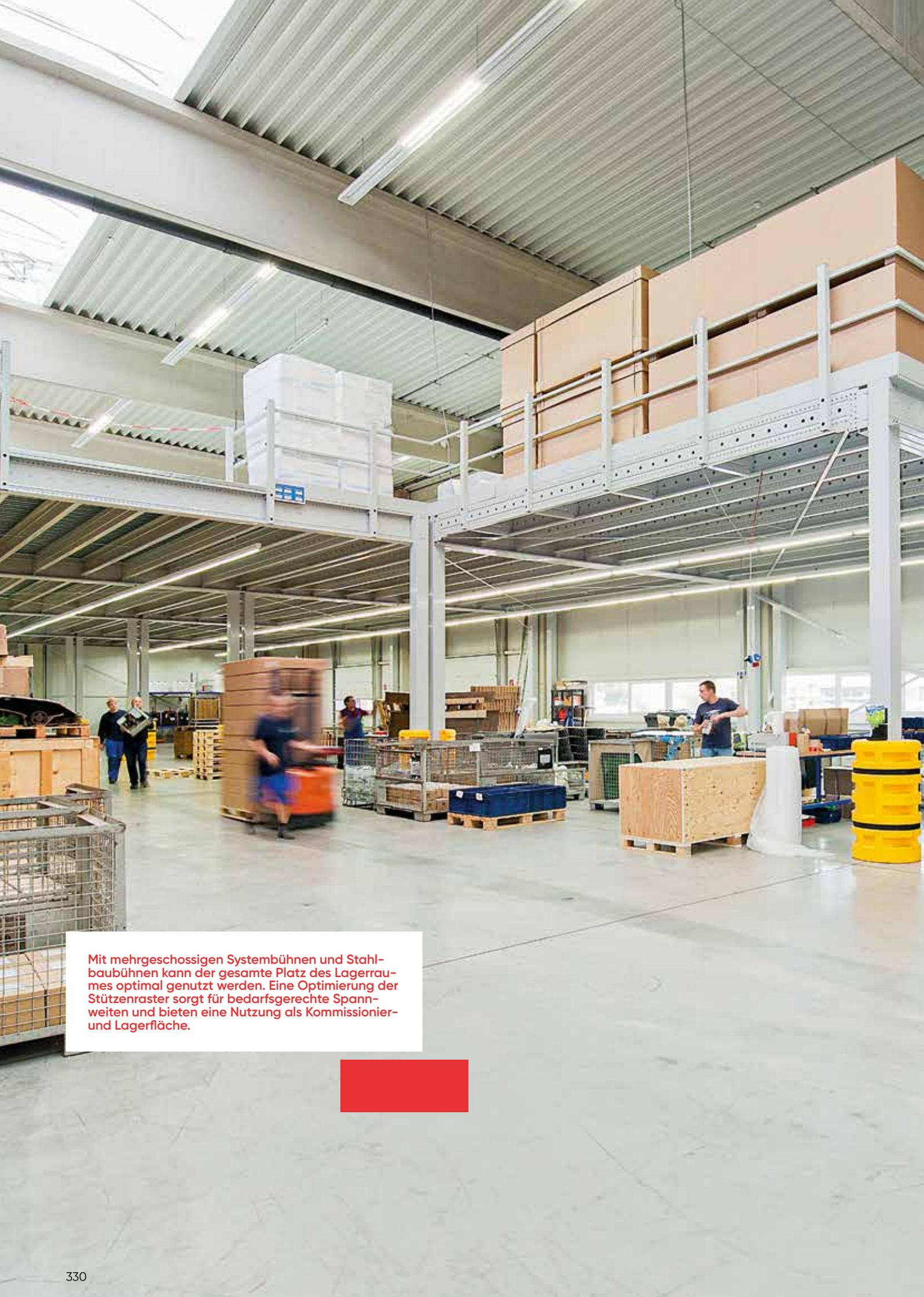
Mit mehrgeschossigen Systembühnen und Stahlbaubühnen kann der gesamte Platz des Lagerraumes optimal genutzt werden. Eine Optimierung der Stützenraster sorgt für bedarfsgerechte Spannweiten und bieten eine Nutzung als Kommissionier- und Lagerfläche.
