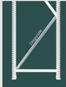
**Diagonalstrebe für Rahmenfachwerk MULTILOAD**
