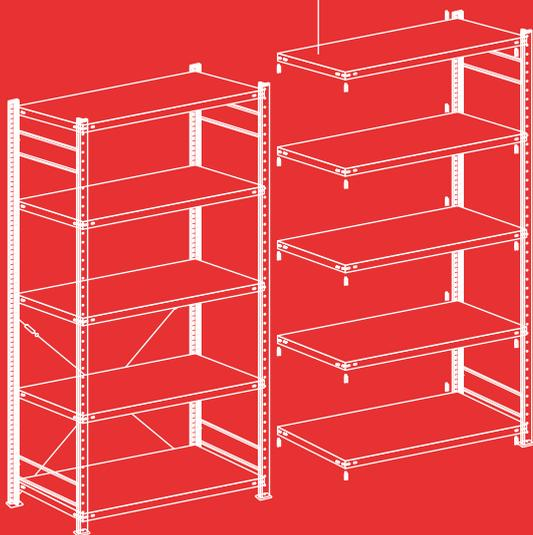
Mittels Steckverbindung sind diese Fachbodenregale schnell und einfach zu montieren. Sie können für Einzel- und Doppelregale sowie mehrgeschossige Regalanlagen eingesetzt werden.
