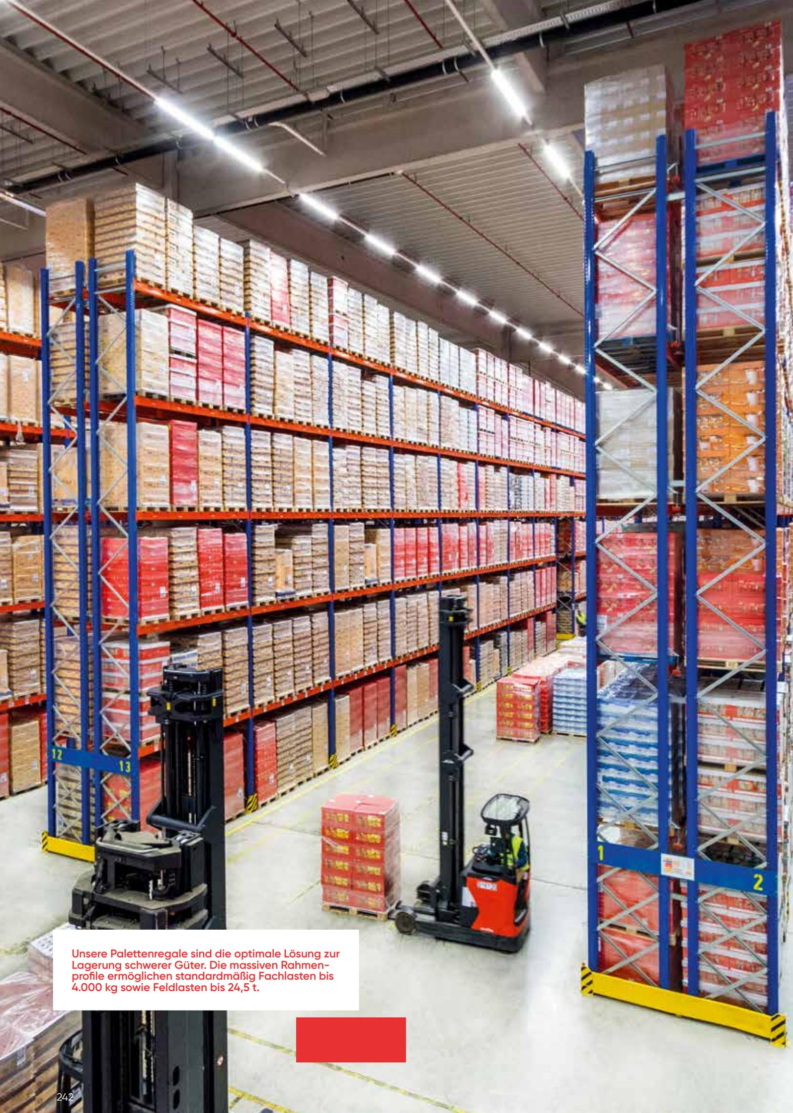
Unsere Palettenregale sind die optimale Lösung zur Lagerung schwerer Güter. Die massiven Rahmenprofile ermöglichen standardmäßig Fachlasten bis 4.000 kg sowie Feldlasten bis 24,5 t.
